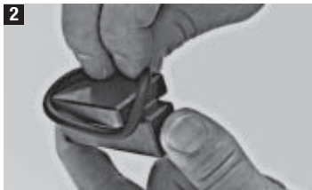
2 Einen neuen O-Ring über das Schlagstück, wie abgebildet, stülpen.
