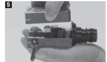
5 Die obere Gehäusehälfte auf die untere setzen und mit den vier Schrauben (M6x30) unter Verwendung von Loctite und einem Sechskantschlüssel fest zusammenschrauben.
