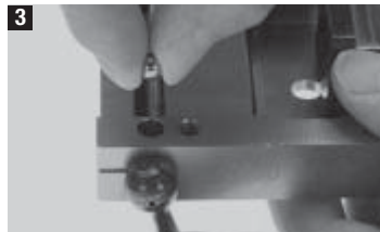
3 Die Achse mit Verriegelungshebel in die Bohrung, wie abgebildet, einsetzen und Kugel in die Bohrung legen. (Achtung: Die Kugel nicht verlieren!)
