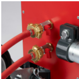
Vízbevezető a vágási helyre
